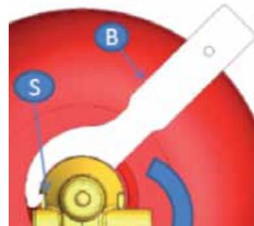
Verificare il corretto posizionamento dell'OR valvola "A" sotto la flangia del corpo valvola. Inserire il dente della chiave dinamometrica "B" nello spacco "S" della valvola. Avvitare la valvola sul serbatoio con coppia di serraggio compresa tra 50 Nm e 80 Nm.
